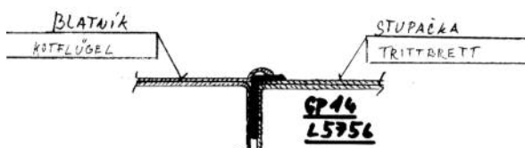
Umístění gumy mezi blatník a stupačku u vozů Aero 30, 50 - model 1939.- Lokalisierung von Gummi zwischen Kotflügel und Trittbrett des Aero 30 Autos, 50 Modell - die 1939. -
